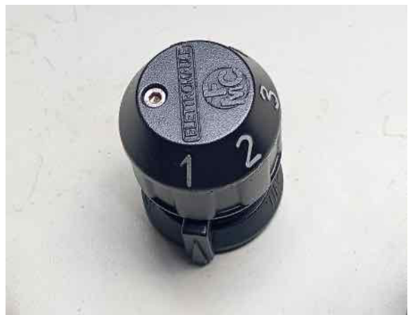
ตำแหน่งแท็ปปรับแรงดัน : Tap Changer
