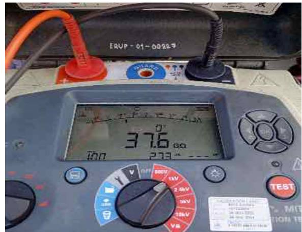
ค่าความเป็นฉนวนระหว่างขดลวดแรงสูงกับดิน: HV-G
